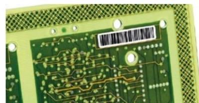
Questo film in poliammide bianca ha tutte le proprietà necessarie per l'esposizione a elevato calore mantenendo la bianchezza, la leggibilità dei codici a barre e l'adesione quando viene esposto a 300°C per un minuto. Offrono inoltre un'eccellente resistenza all'abrasione e alle sbavature della stampa. La superficie liscia, omogenea e l'opacità consentono una stampa ad alta risoluzione con gli inchiostri convenzionali e la stampa a trasferimento termico.
